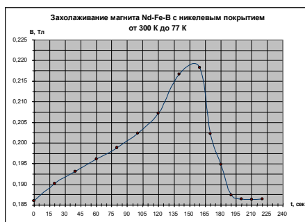
Рис 2 Изменение магнитной индукции редко земельных магнитов Nd-Fe-B при 77 К (а) и ротор дискового типа синхронного двигателя с постоянными магнитами (б)
