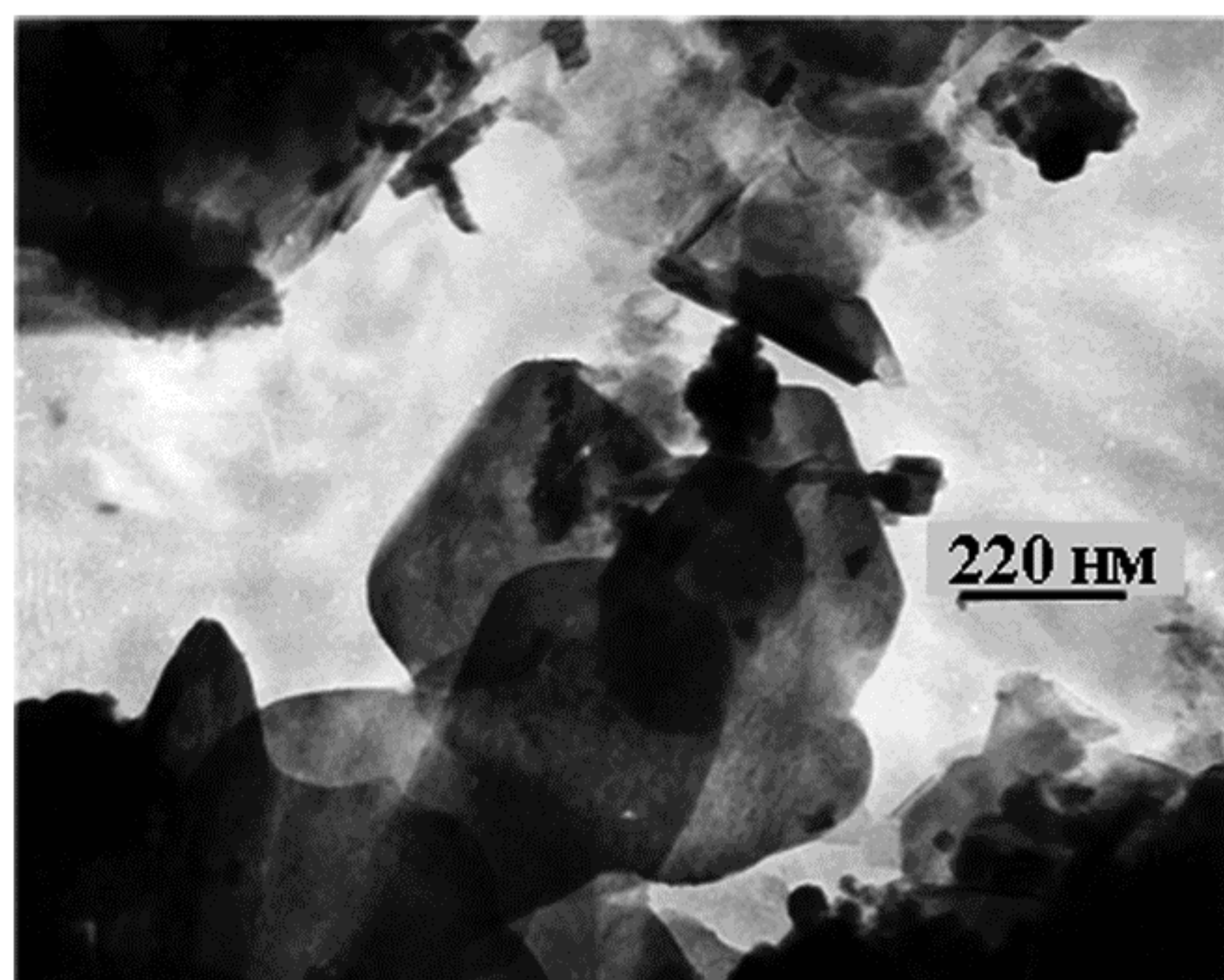
Рис. 3. Mg-Fe-гидросиликат (\text{Mg,Fe})_3\text{Si}_2\text{O}_5(\text{OH})_4 с пластинчатой формой частиц.
