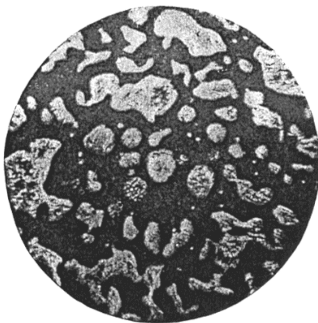
Фиг. 2. Ликвация в системе ZrO_2-SiO_2 (отраженный свет) \times 450
