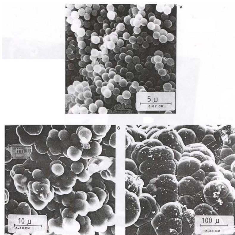
Рис.1. Снимки поверхности твердых отложений кремнезема скважины BR22 месторождения Вайракей (Новая Зеландия) отложения в виде отдельных частиц на начальной стадии течения раствора ( а ), отложения на следующей стадии после начала образования комплексов частиц ( б ), отложения на заключительной стадии после заполнения пустот ( в ).
